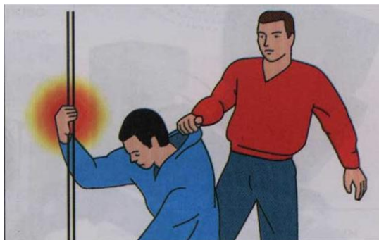
Рисунок 6 - Освобождение пострадавшего от тока для ЭУ напряжением до 1000 В оттащиванием за сухую одежду
