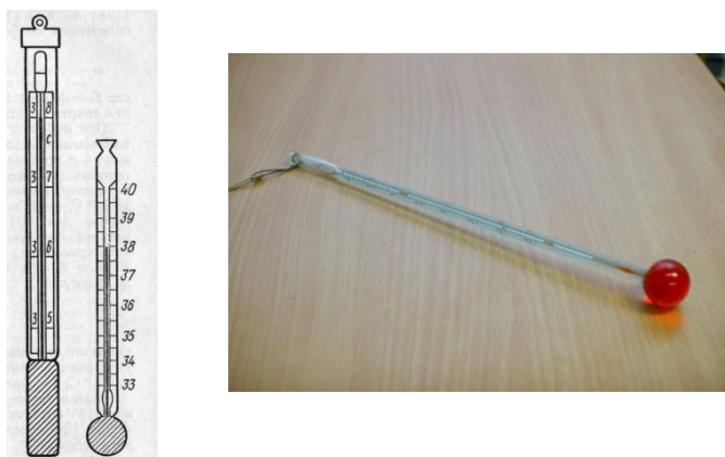
Рисунок 10 - Кататермометр цилиндрический и шаровой
