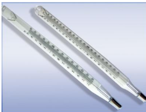
Рисунок 1 - Максимальные термометры - ртутные
