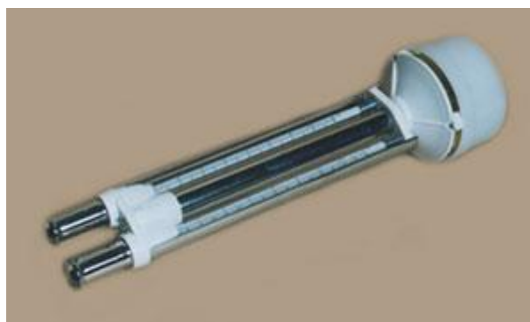
1 - вентилятор, 2 - психрометрические термометры; 3 - пипетка для смачивания влажного термометра
