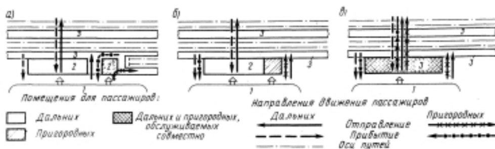
Рис. 1.1. Планировочные схемы вокзалов в зависимости от преобладающей категории обслуживаемых пассажиров, функционального и объемно-планировочного решения: а – самостоятельные (раздельные); б – полураздельные (общий вокзал, раздельные элементы); в – единые (общие); 1 – привокзальная площадь; 2 – пассажирское здание; 3 – платформа
