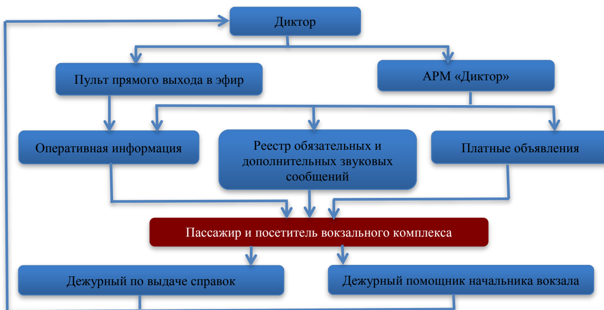
Рисунок 10.1 – Технологическая схема информационного обслуживания пассажиров и посетителей вокзального комплекса
