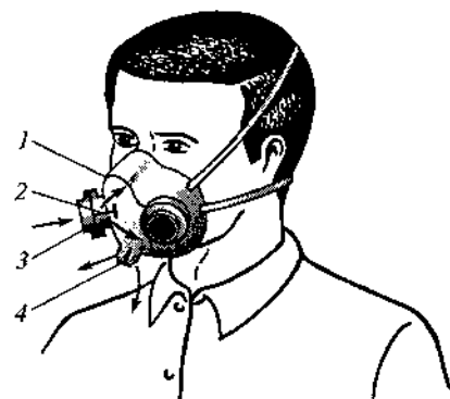
Рис. 4.1. Патронный респиратор: 1 — полумаска; 2 — клапан вдоха; 3 — фильтрующий патрон; 4 — клапан выдоха
